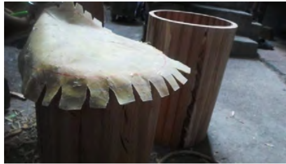
174_Forma del corte de la membrana o tapa de cuero para costura.
