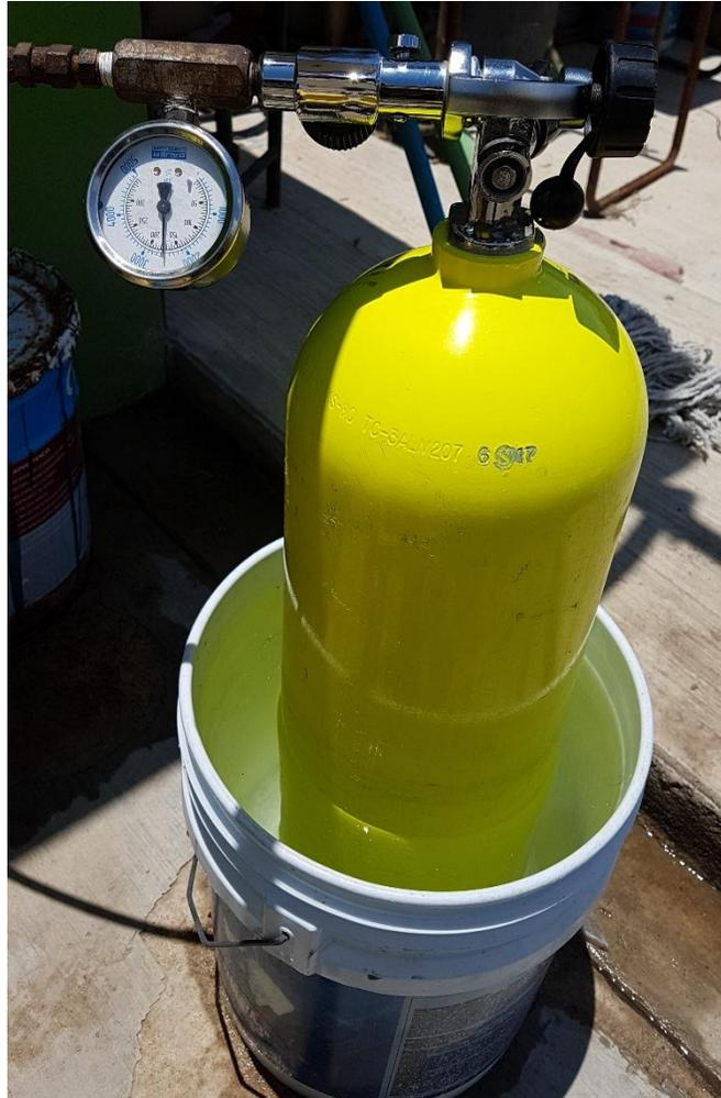
Figura 17. Tanque e proceso de llenado sumergido en un contenedor con agua para evitar que se caliente demasiado. Foto por: Oscar Sánchez, 2018.
