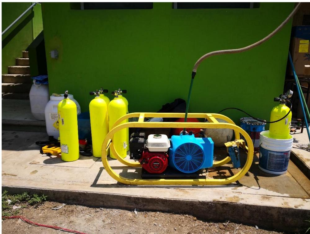
Figura 40. Llenado de tanques con el compresor "A", modelo Honda GX 270. Foto por: Oscar Sánchez, 2018.
