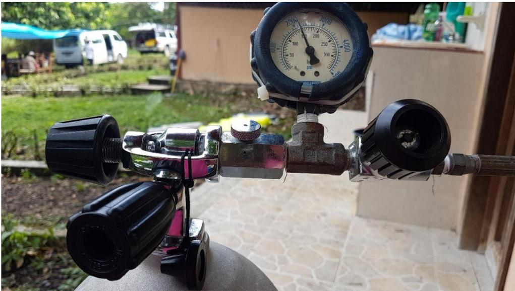
Figura 19. Tanque conectado correctamente al compresor, la válvula marca 2100 PSI, casi listo para desconectarse. Foto por: Noemí Ovando, 2018
